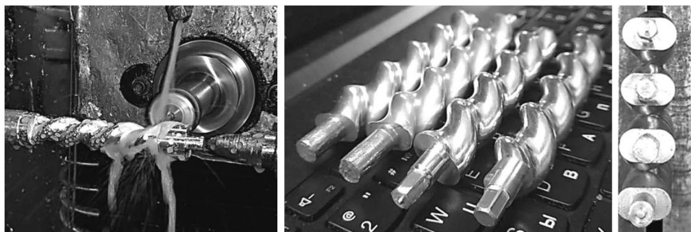
Рис. 7. Винтовые роторы, обработанные фрезами различного диаметра.
